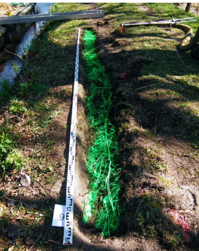
ILUSTRACJA Przykładowy wykop w celu ustalenia położenia korzeni na prawym brzegu kanału Störkanal.
