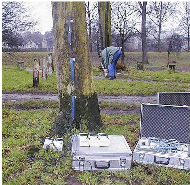
Stabilność – test obciążeniowy - bezinwazyjna i pewna metoda badania ryzyka upadku drzewa, WESSOLLY 1987.
