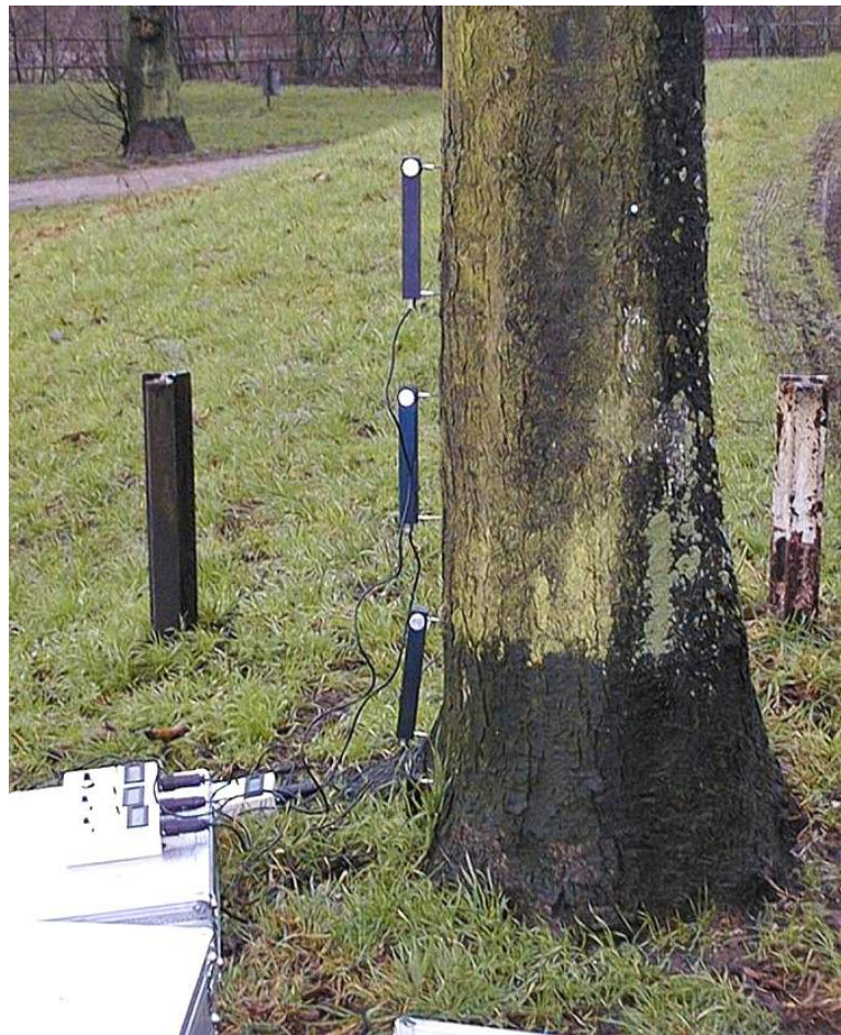
Stabilność – test obciążeniowy - bezinwazyjna i pewna metoda badania ryzyka upadku drzewa, WESSOLLY 1987.
