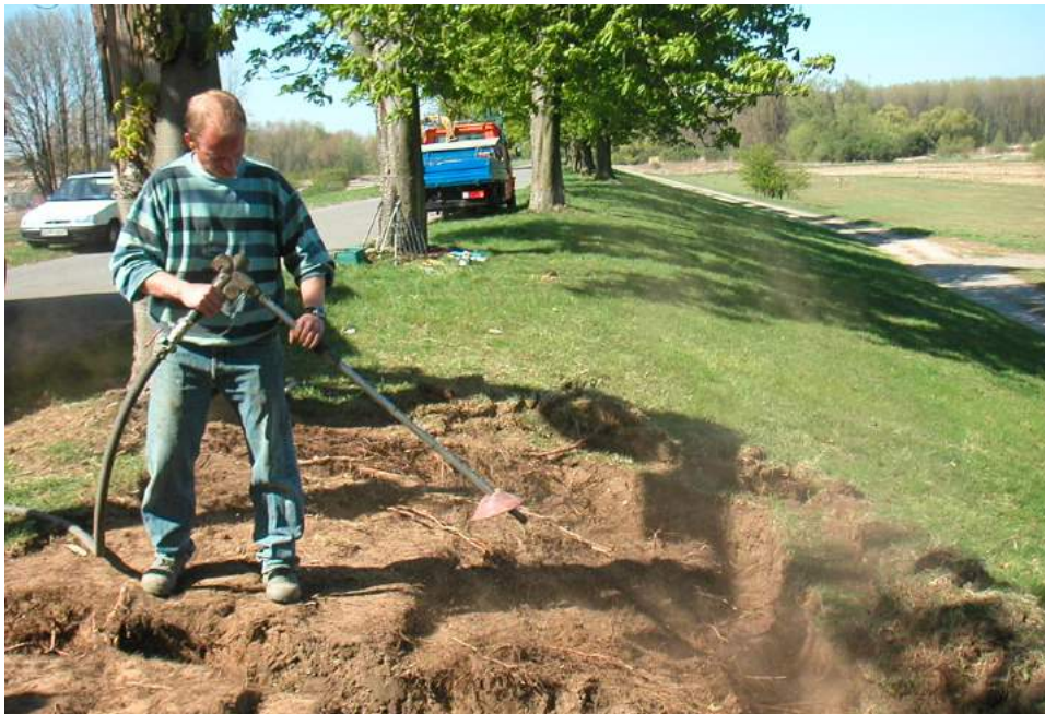
ILUSTRACJA pokazują gęsty system drobnych korzeni kasztanowca pod trawą, przez którą nie można się przebić nawet przy pomocy aparatu podającego wodę pod ciśnieniem. System korzeniowy jak worek trzyma mieszaninę ziemi i piasku, z których zbudowany jest wał, stabilizuje statykę w przypadku przemoczenia i zapobiega wymywaniu materiału wału. (WESSOLLY 2002).
