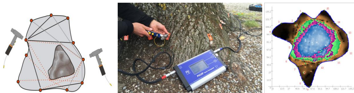
Abbildung 4: Schalllaufwege, Mitte: Schallmessung an einer Linde (Typ: PiCUS Schalltomograph), Rechts: Schalltomogramm
