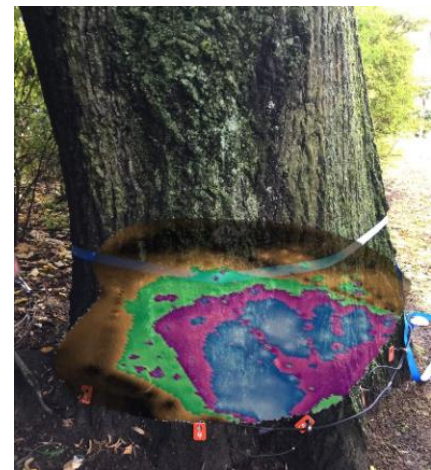
Abbildung 3: Schalltomogramm einer Linde
