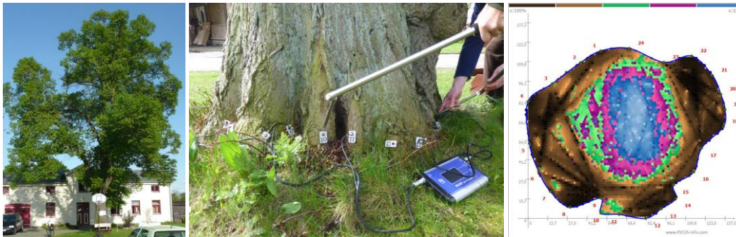
Abbildung 14: Linde Ansicht von Westen. Schallmessung auf Bodenniveau. Schalltomogramm
