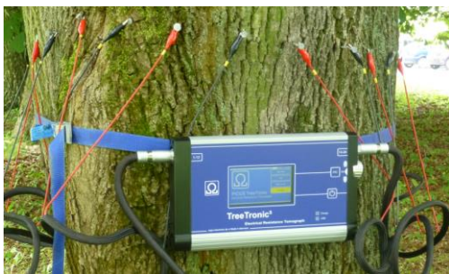
Abbildung 5: Widerstandstomograph (Typ: TreeTronic) 3D Grafik von 3 ERT's, ERT einer gesunden Buche
