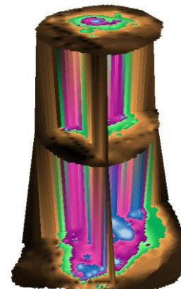
Abbildung 19: Windkippkurven dreier benachbarter Douglasien; Rechts: 3D Grafik der Schallungen bei 29, 100 und 160 cm
