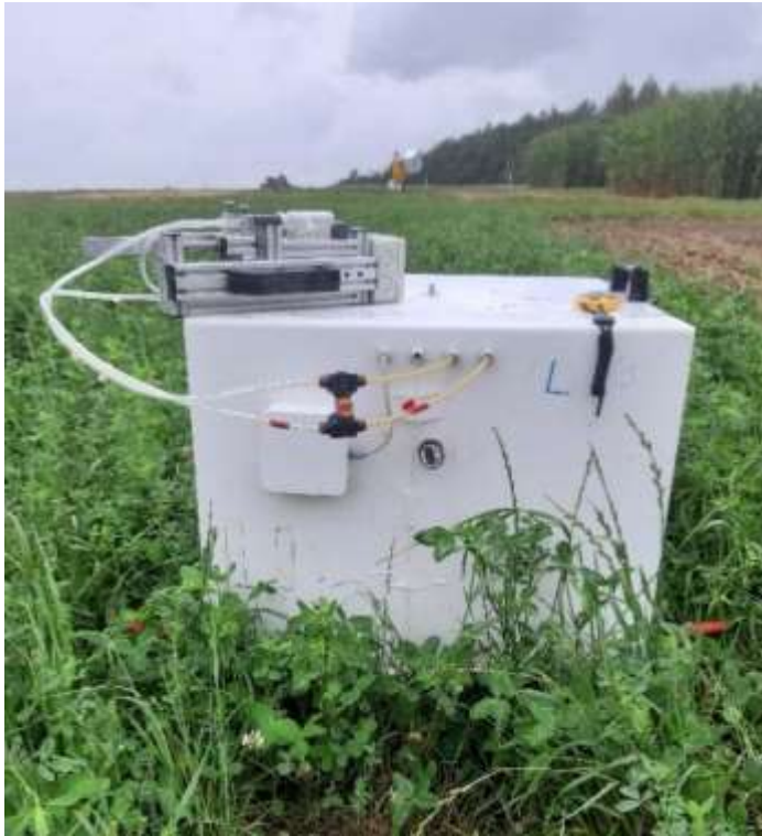
Lachgasmessung mit der Closed-Chamber-Methode in einem Klee grasbestand (links) und in einem Weizenbestand mit Haubenverlängerung (rechts) in der Versuchsstation Viehhausen der Technischen Universität München
