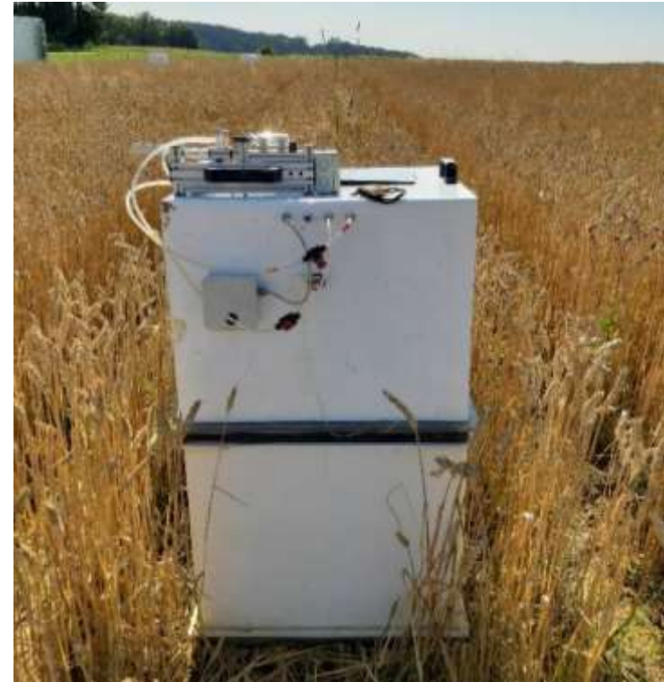
Lachgasmessung mit der Closed-Chamber-Methode in einem Klee grasbestand (links) und in einem Weizenbestand mit Haubenverlängerung (rechts) in der Versuchsstation Viehhausen der Technischen Universität München
