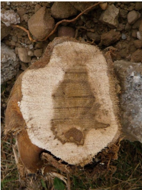
Abb. 7: Fäule 30 cm hinter Kappstelle
